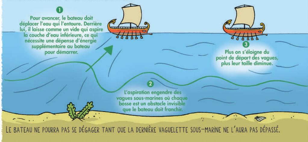
POUR COMPRENDRE CE PHÉNOMÈNE, IL FAUT L'OBSERVER EN LABORATOIRE GRÂCE À UN BAC EMPLI D'EAU ET UNE MAQUETTE DE BATEAU TRACTÉE PAR UN CÂBLE.
