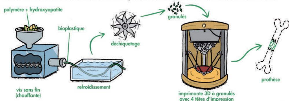
LA BONNE CHALEUR ET LA VITESSE DE ROTATION DE LA VIS SANS FIN SONT DÉLICATES À TROUVER POUR OBTENIR UN MATÉRIAU UTILISABLE EN IMPRESSION 3D AVEC LES PROPRIÉTÉS MÉCANIQUES ET BIOLOGIQUES RECHERCHÉES !
